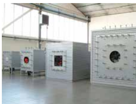
Túneis Aerodinâmicos para determinar as prestações caudal-pressão dos ventiladores.
