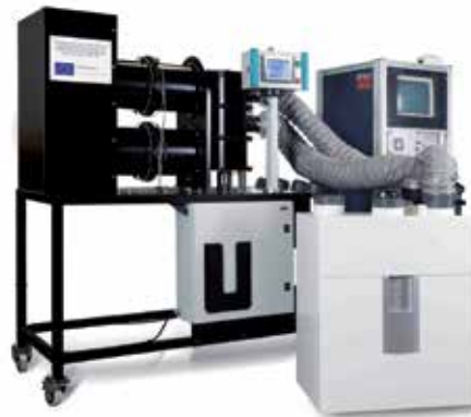
Câmara de fugas
