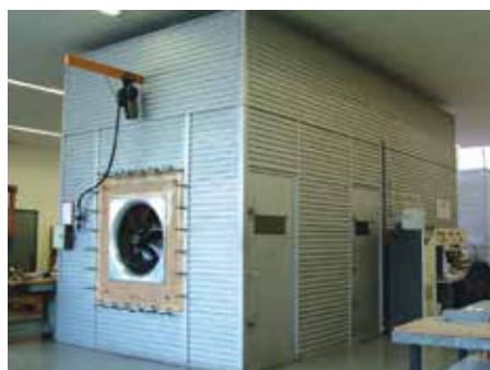
Túneis Aerodinâmicos para determinar as prestações caudal-pressão dos ventiladores.
